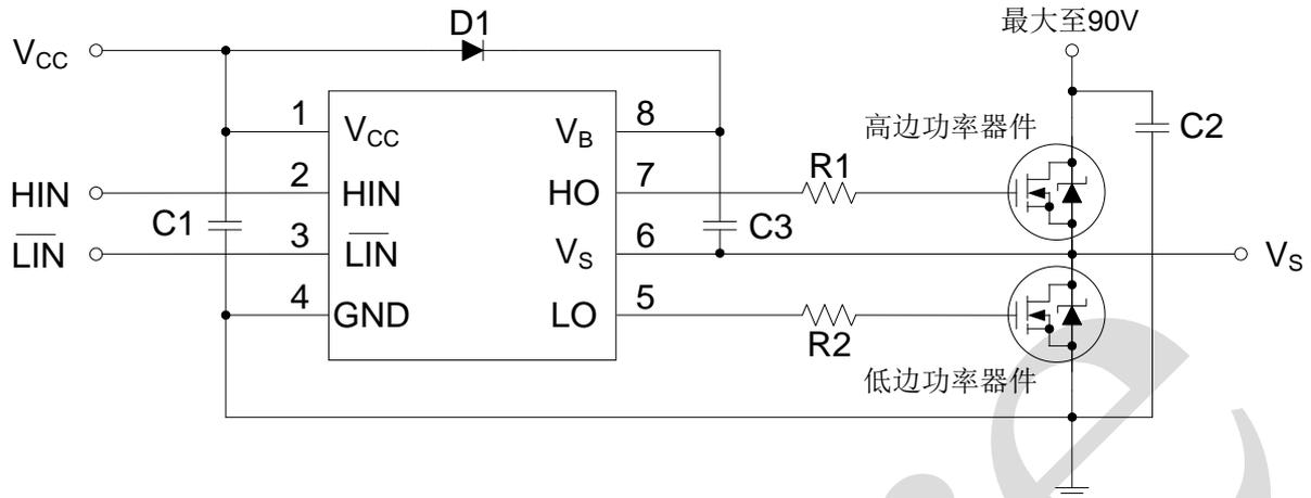
C1: 低边电源滤波电容, 参考电容值: 0.1 $\mu$ F~1 $\mu$ F;
